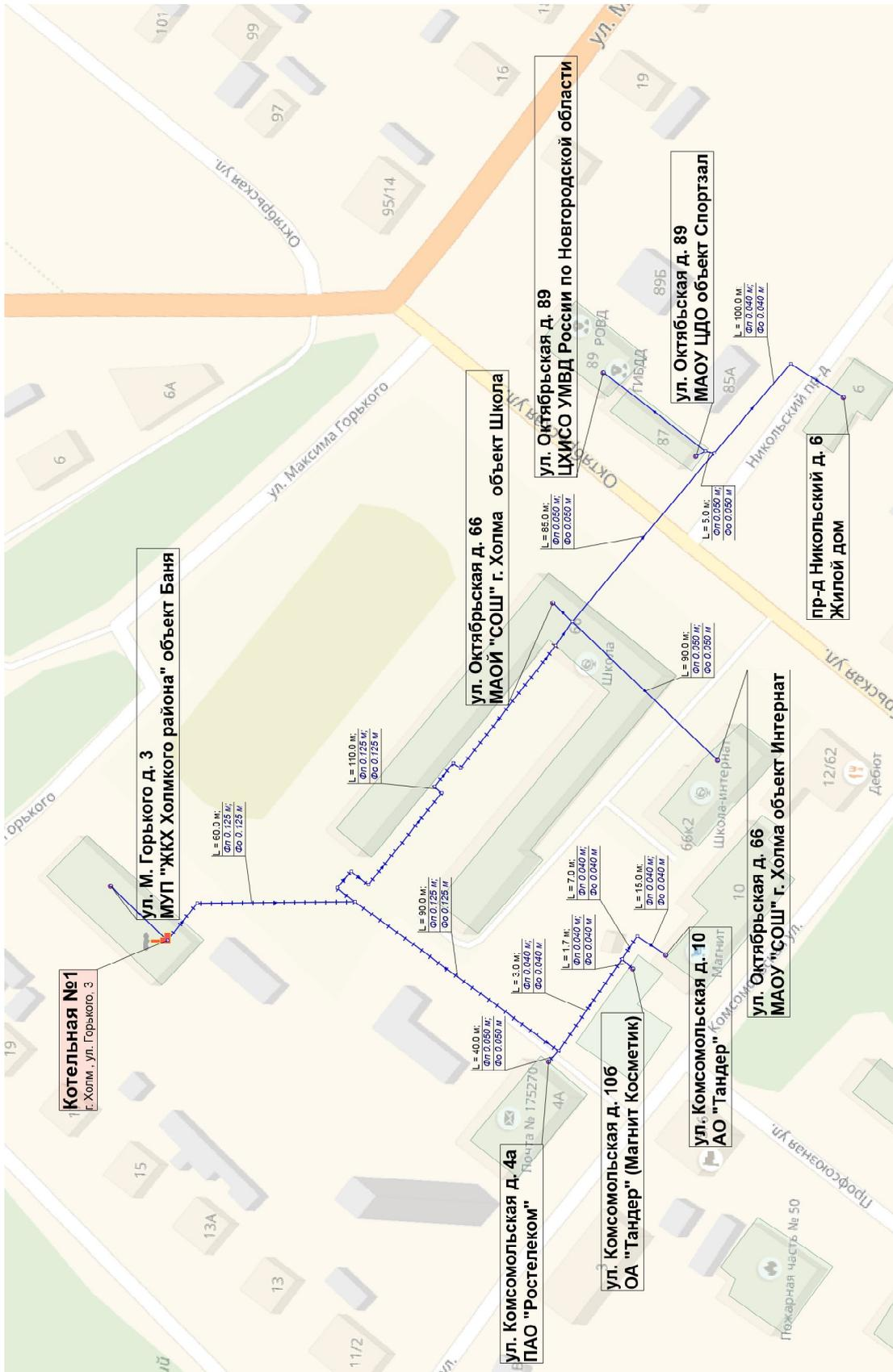
Рисунок 1.1. - Схема тепловых сетей Котельной № 1, г. Холм, ул. Горького, д. 3
